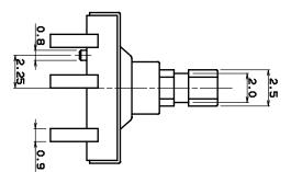
3.RATING : MAX 50mA . 12V DC 6.FEATURE : MULTI THIN TYPE, REFLOW SOLDERING 5. CONTACT RESISTRANCE : 100mg MAX 4.STROKE (mm) : 4-DIRECTION 0.4 ±0.1 , CENTER : 0.2±0.1 2.LIFE CYCLE : FOR EACH 50,000 CYCLE 1. OPERAING FORCE : 4-DIRECTION 160 ±30 . CENTER : 320 ±70
